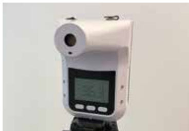
入館する方全員を検温する体温測定システム
